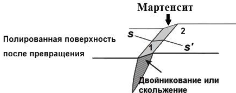
Рисунок 1.1 – Возникновение поверхностного рельефа: 1 – поверхность, 2 – нацарапанная линия [11]
