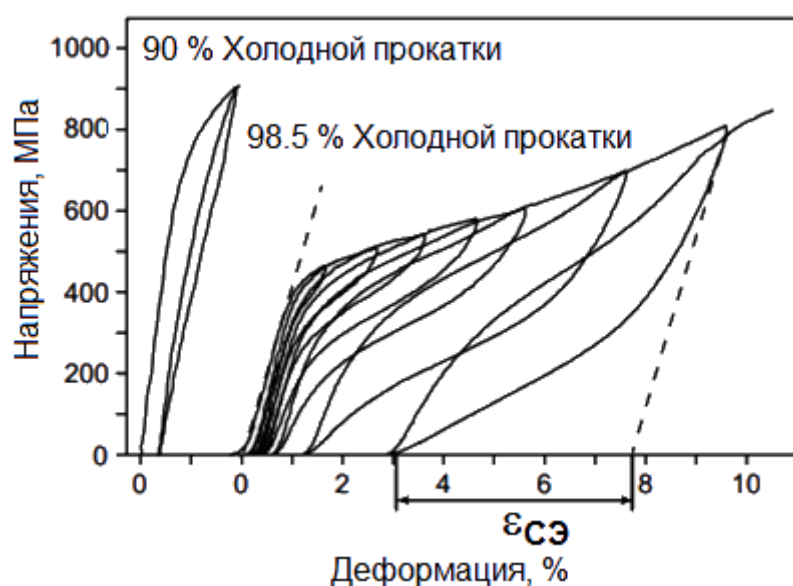
Рисунок 2.2 – Изменение кривой \sigma(\epsilon) от величины заданной деформации растяжением при комнатной температуре для поликристаллов сплава Fe–28Ni–17Co–10Al–2.5Nb–0.05B (ат.%) при старении 600 °C, 96 часов [46]
