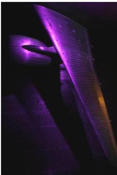
Рисунок 3.5 – Вид модели с наклеенными минишелковинками
