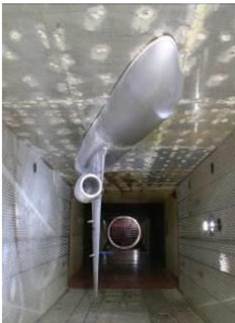
Рисунок 3.1 – Исследуемая полумодель самолета в АДТ Т-128
