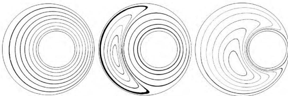
Рис. 2.6. Линии тока при вращательном течении в эксцентрическом канале.  $\theta = 0.4$ ,  $Re_\omega = 100$ ,  $e = 0.3$ ,  $e = 0.5$ ,  $e = 0.99$
