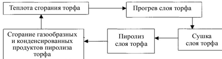
Рис. 1.2. Схема основных физико-химических процессов во фронте торфяного пожара [13]
