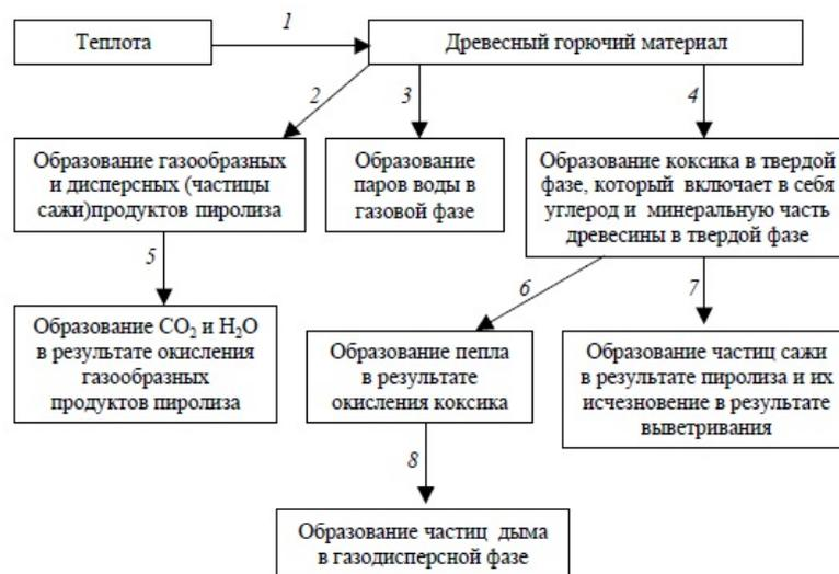
Рис. 1.12. Схема изменения агрегатного состояния и химического состава древесины при ее горении [68].
