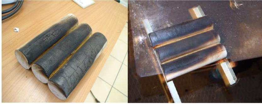
Рис. 3.15. Фотография оцилиндрованных образцов древесины после проведения эксперимента
