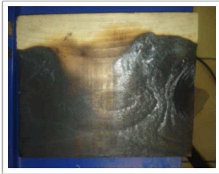
Рис. 3.6. Фотография образца древесины после проведения эксперимента (береза, скорость ветра 3 м/с)
