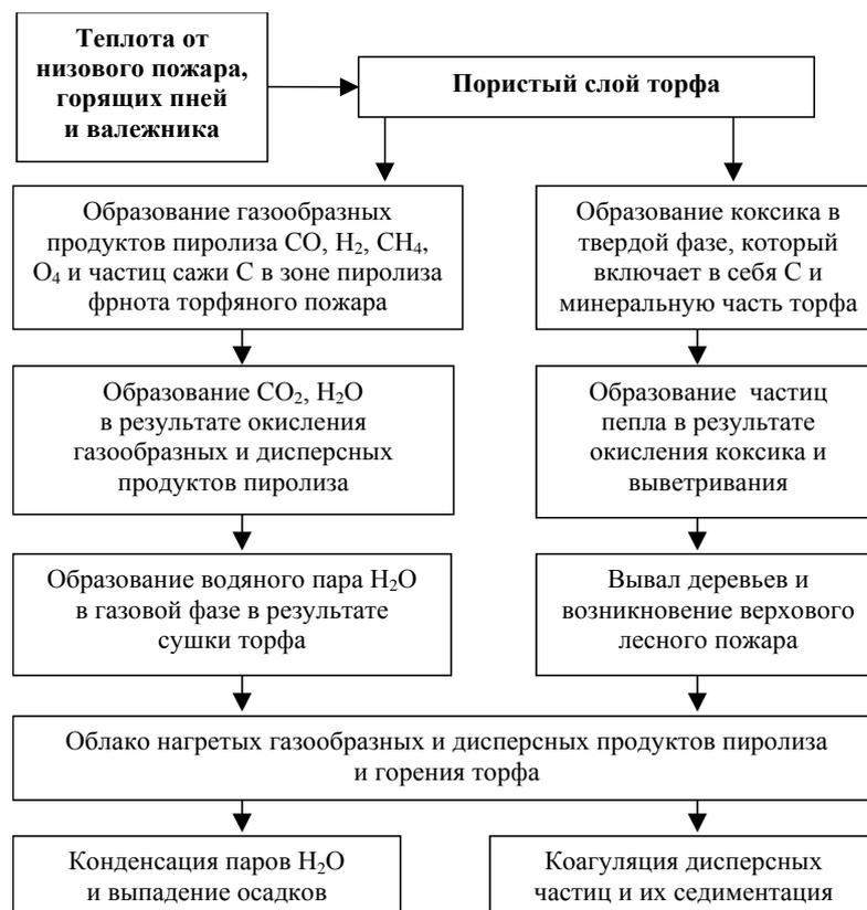
Рис. 1.3. Схема физико-химических процессов и экологических последствий, возникающих при торфяных пожарах [13]
