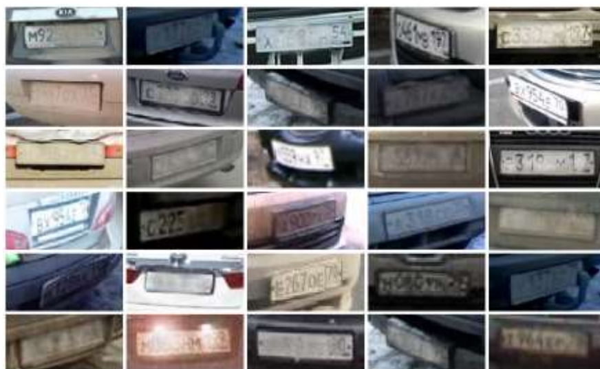
Рисунок 4.17 – Изображения неправильно распознанных автомобильных номерных знаков
