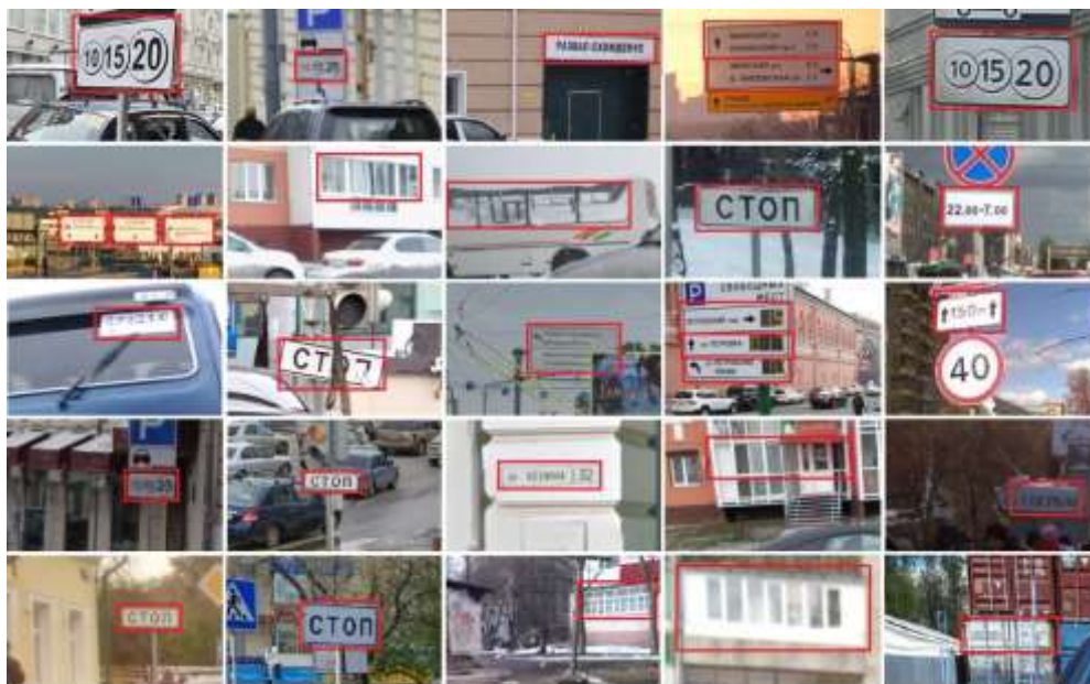
Рисунок 4.8 – Примеры ложных обнаружений, выявленных в процессе тестирования сверточных нейронных сетей
