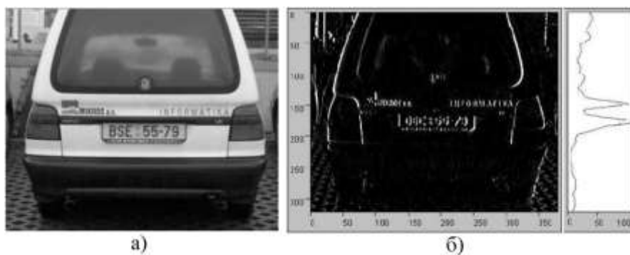
Рисунок 1.1 – Результат применения гистограммного анализа: а) исходное изображение; б) построение гистограмм интенсивности пикселей [144]
