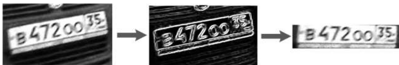
Рисунок 2.14 – Пример нормализации изображения автомобильного номерного знака
