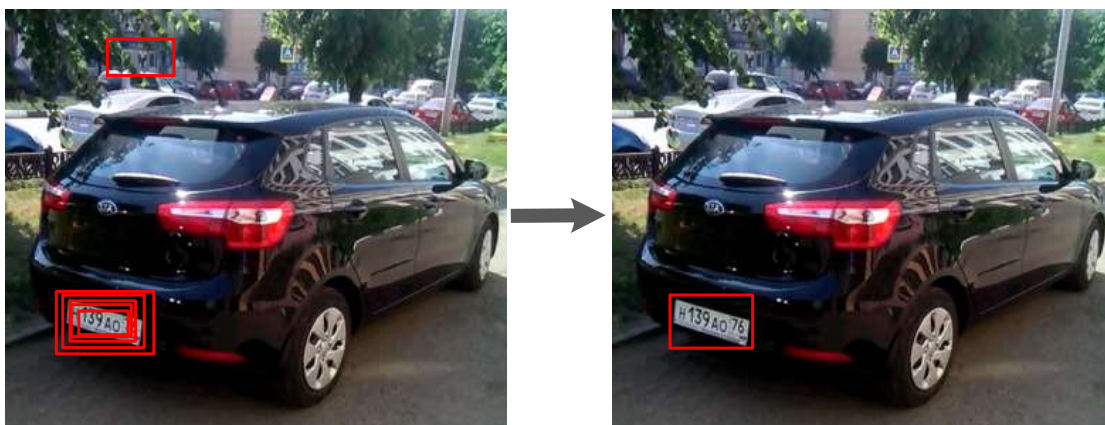
Рисунок 2.7 – Выделение автомобильного номерного знака
