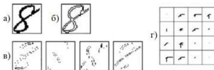
Рисунок 1.13 – Процесс вычисления ориентации штрихов символа [95]
