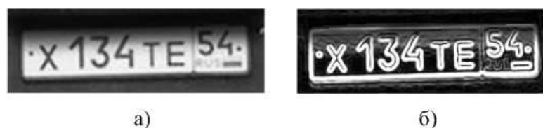
Рисунок 2.10 – Выделение границ на изображении: а) исходное изображение; б) преобразованное изображение
