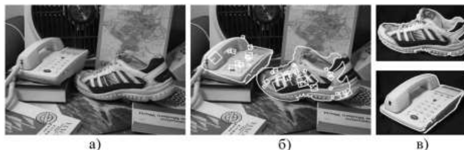
Рисунок 1.2 – Пример работы дескрипторов: а) исходное изображение; б) вычисление признаков; в) обнаруженные объекты [142]
