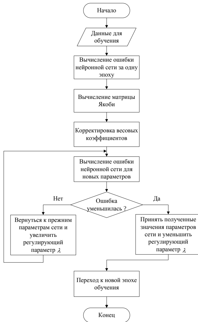
Рисунок 3.6 – Логическая схема алгоритма обучения сверточных нейронных сетей
