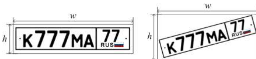
Рисунок 2.12 – Изменение высоты и ширины изображения при различных углах наклона пластины номерного знака ( h и w – высота и ширина изображения соответственно)
