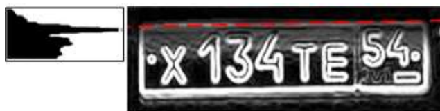
Рисунок 2.13 – Построение горизонтальных гистограмм в верхней части изображения
