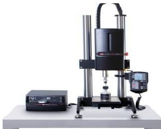
Рисунок 3.3 – Машина для испытания материалов на растяжение INSTRON
