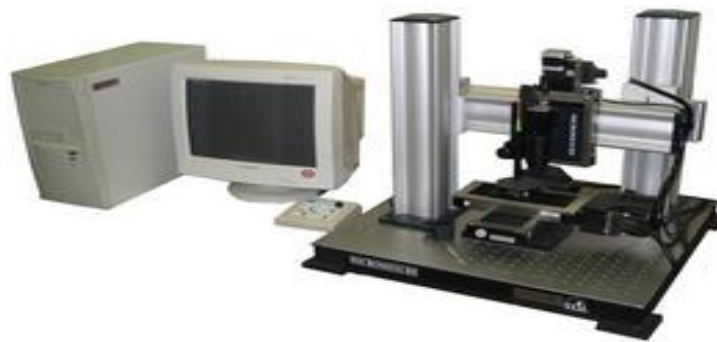
Рисунок 3.2 – Бесконтактный профилометр Micro Measure 3D Station
