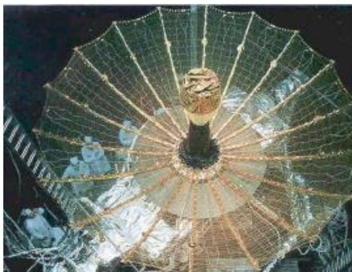
Рисунок В.4 – Рефлектор с жесткими спицами диаметром 5 м
