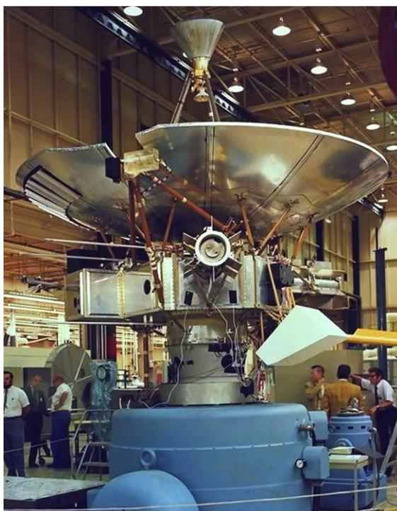
Рисунок В.1 – Параболическая антенна космического аппарата Pioneer-10
