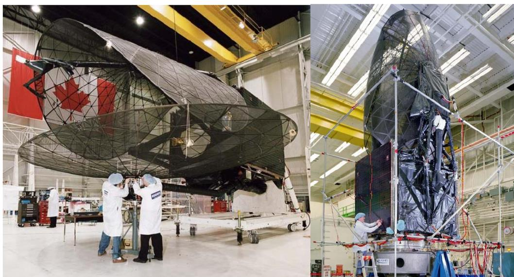
Рисунок В.9 – Рефлектор типа spring-back
