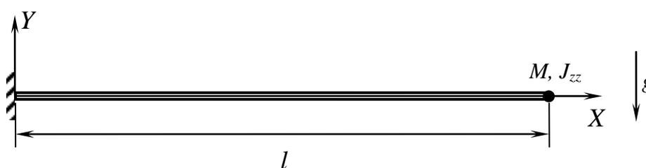
Рисунок 3.5 – Защемленная балка с грузом на свободном конце
