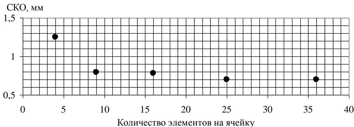
Рисунок 3.19 – Зависимость СКО от количества элементов в ячейке сетеполотна
