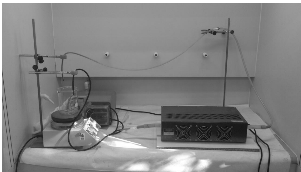
Рисунок 2.4 – Малогабаритный проточный фотореактор на основе KrCl эксилампы
