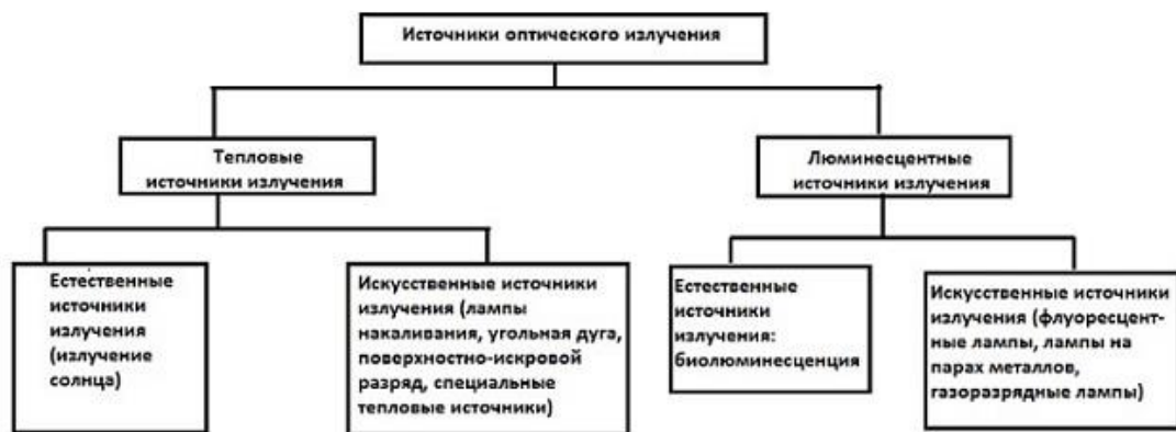
Рисунок 1.12 – Общая классификация источников оптического излучения
