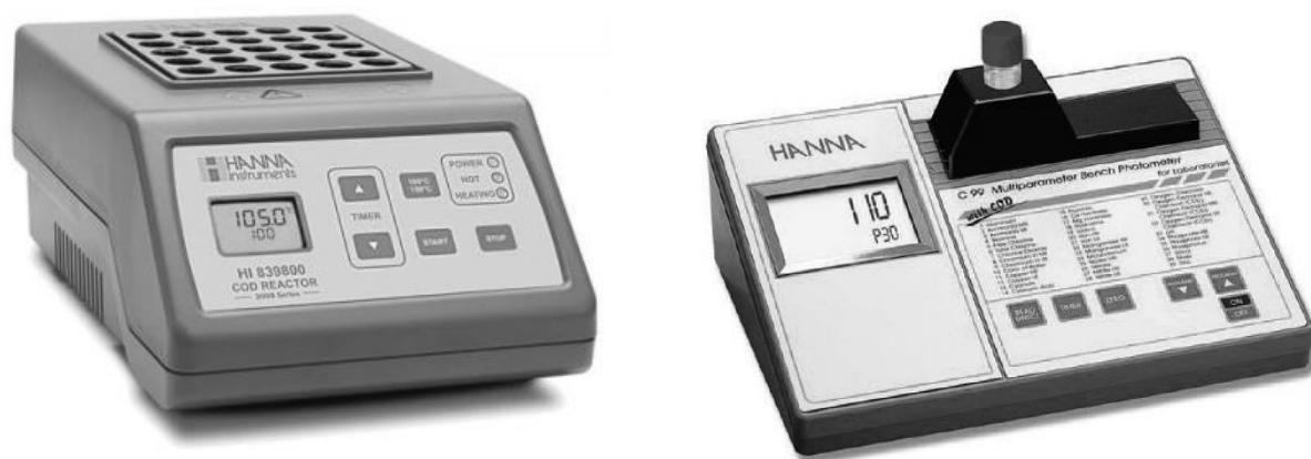
Рисунок 2.5 – Определение ХПК. (слева) Реактор для проб, (справа) колориметрическое определение содержания ХПК в полученных пробах
