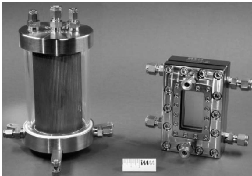
Рисунок 1.20 – Внешний вид цилиндрического микрореактора с падающей пленкой и его стандартной версии [55]
