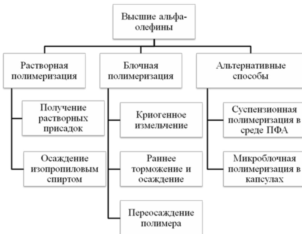
Рисунок 1.11 – Классификация способов получения противотурбулентных присадок
