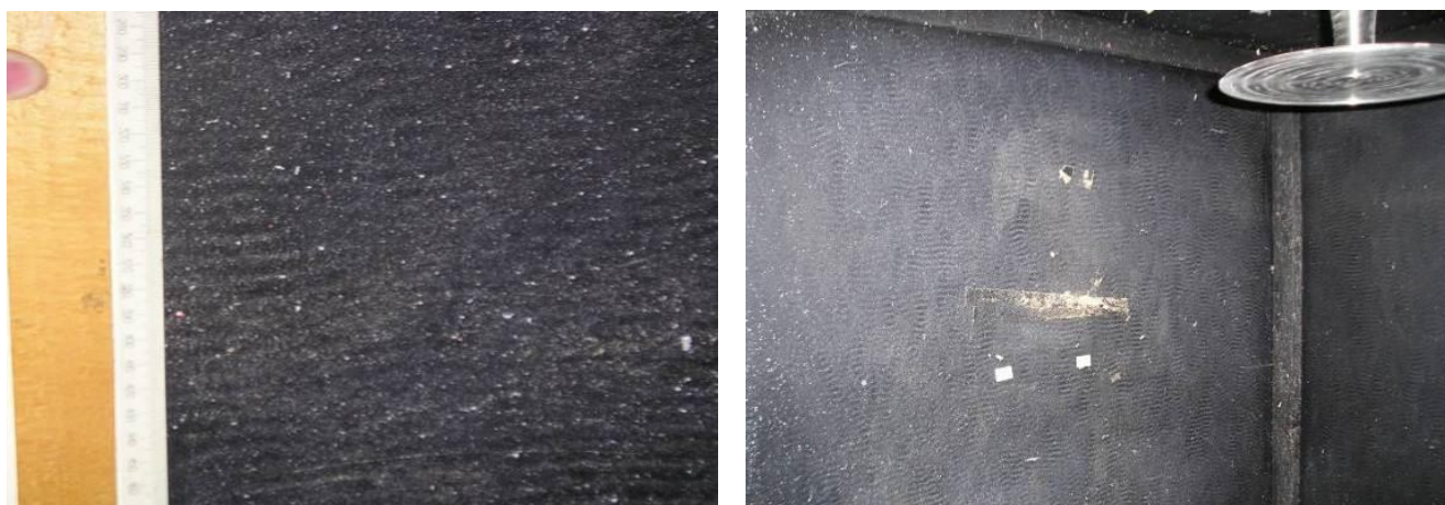
Рисунок 4.20 – Фотографии стенки экспериментальной камеры после воздействия ультразвуком на распыленную мучная пыль
