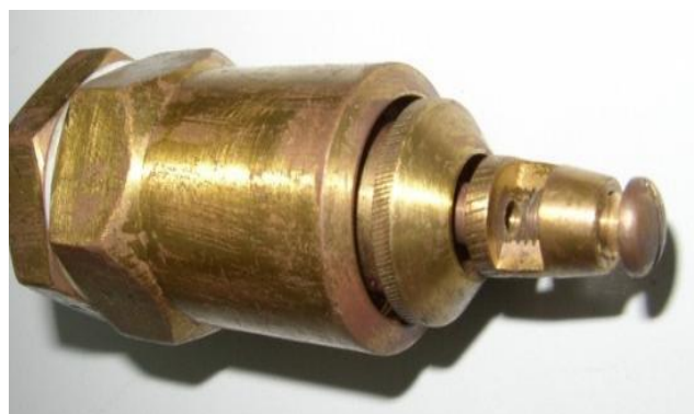
Рисунок 2.5 – Конструкция и фотография газоструйного широкополосного излучателя
