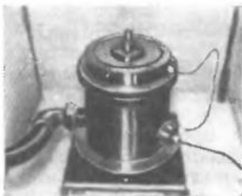
Рисунок 2.6 – Ультразвуковая сирена (внешний вид)
