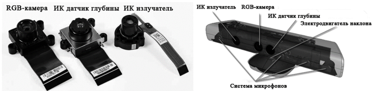
Рисунок 8 – Физическое устройство и внутренние компоненты Microsoft Kinect
