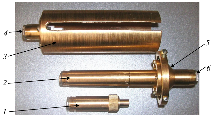
Рисунок 2.11 – Вид устройства и ячеек для измерения КДП. 1 – коаксиальная ячейка сечением 7/3 мм с разъемами для измерения КДП волноводным методом; 2 – коаксиальная ячейка, присоединенная к центральному проводнику линии большого сечения 3; 4, 6 – СВЧ разъемы линии большого сечения; 5 – согласующий отрезок конической линии
