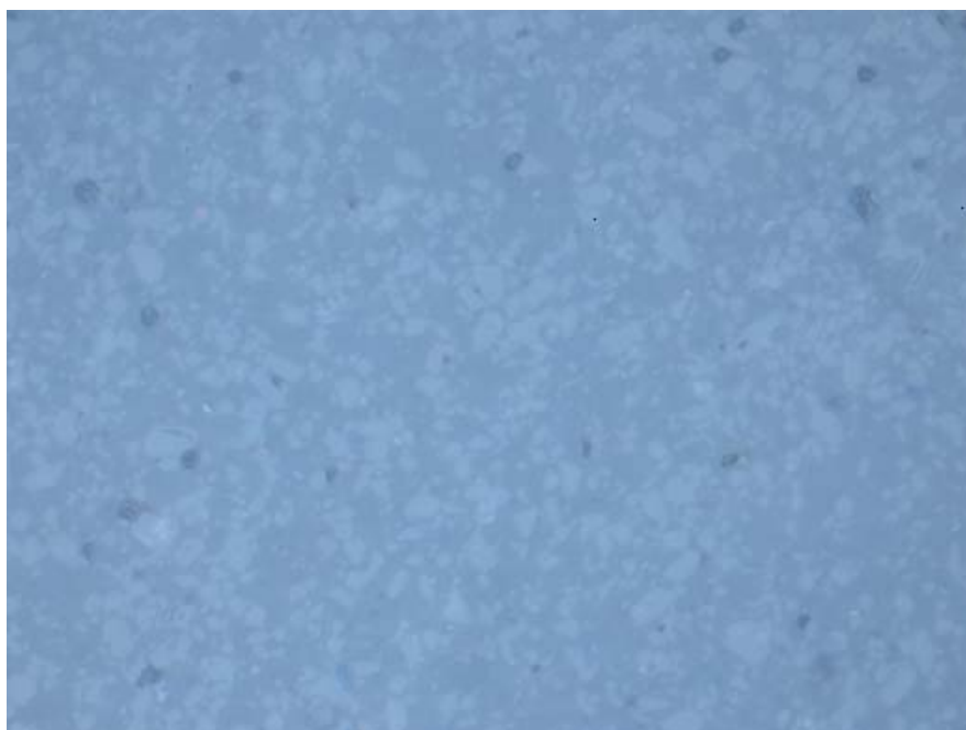
Рисунок 20 - Поры в композите \text{Al}_2\text{O}_3\text{--ZrO}_2
