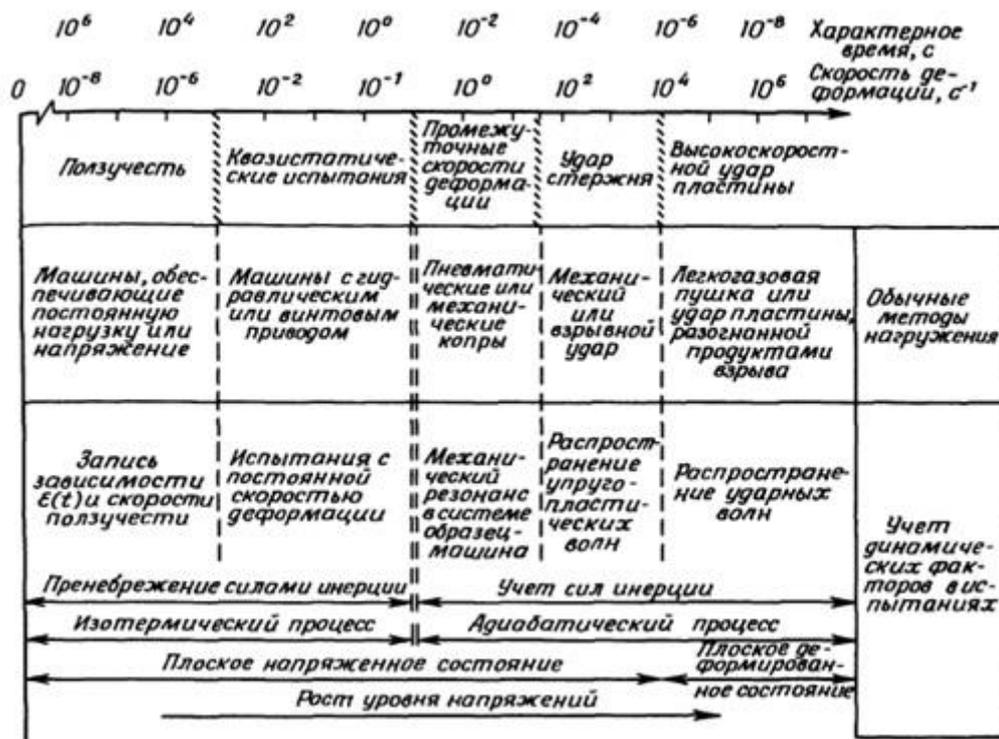
Рисунок 1.1.1 – Динамическая классификация механических испытаний [22]
