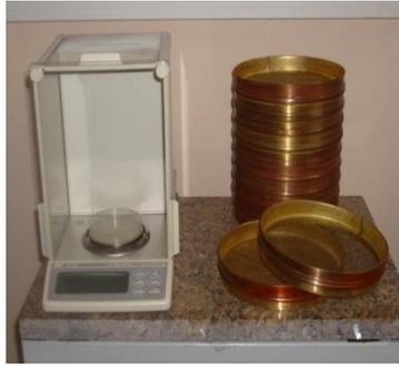
Рисунок 2.3.1 – Электронные весы HR-202i (погрешность 0.0001 г) и лабораторные сита
