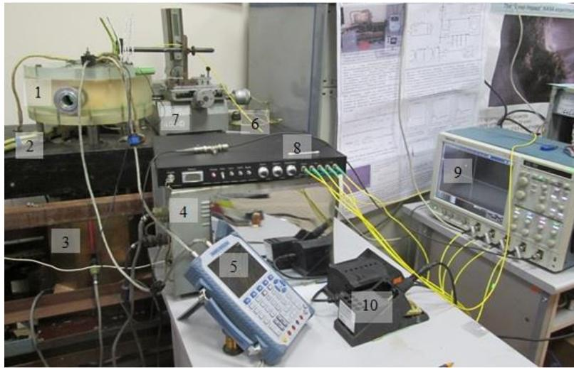
Рисунок 3.1.2 – Экспериментальная измерительная система по исследованию физико-механических свойств жидкости. Установка ЭВП и система VISAR: 1 – цилиндрическая камера; 2 – заземление; 3 – система конденсаторов; 4 – источник высокого напряжения; 5 – двухканальный осциллограф; 6 – оптоволоконно для регистрации сигналов в жидкости; 7 – устройство для определения расстояния между местом инициирования взрыва и «зеркалом»; 8, 9 – интерференционная система VISAR; 10 – паяльная станция
