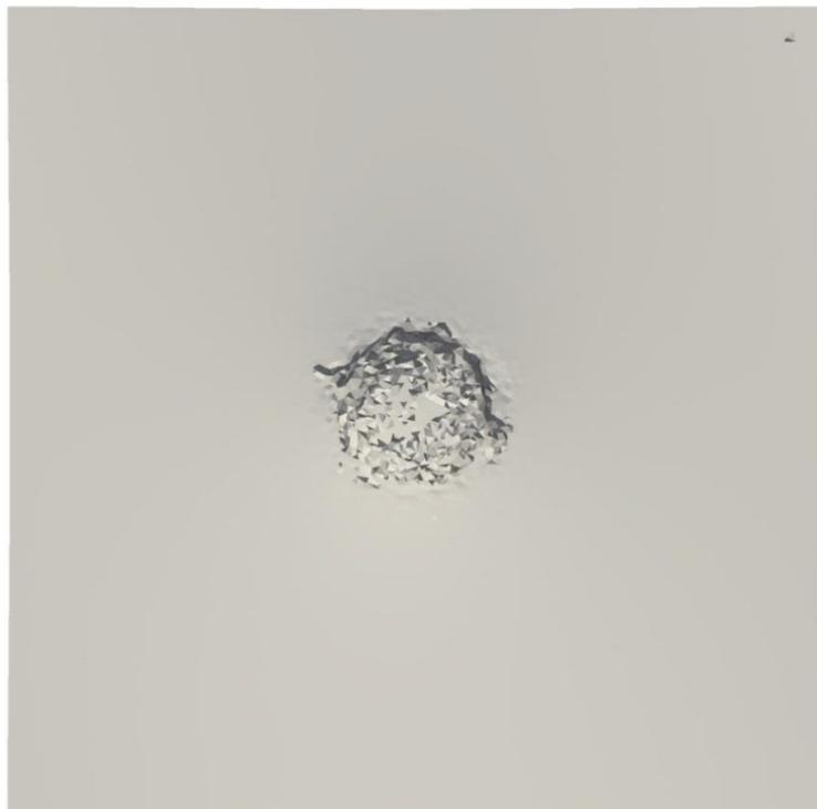
Рисунок 3.4 – Внешний вид кратера на лицевой поверхности второй преграды при численном моделировании.
