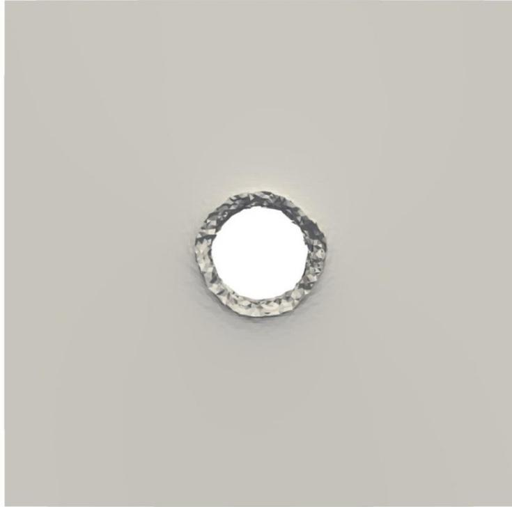
Рисунок 3.3 – Численные результаты внешнего вида тыльной поверхности первой преграды после пробития.
