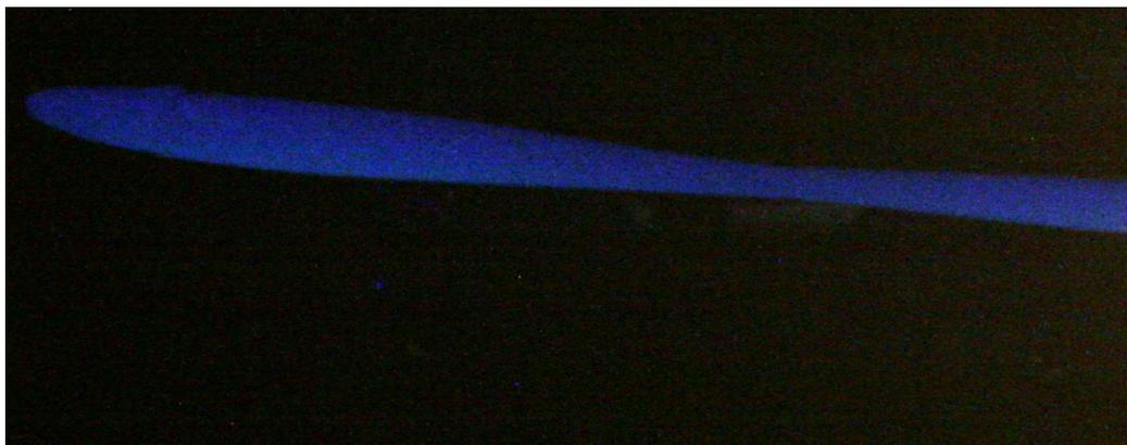
Рис. 3.15 Изменение поперечного размера и формы фронта пламени при его колебаниях
