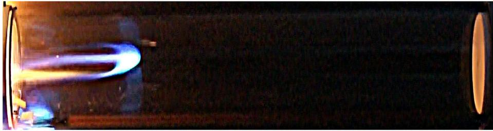
Рис. 4.2 Фронт пламени, распространяющийся в цилиндрической трубе
