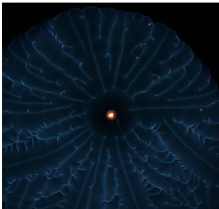
Рис. 3.3 Эволюция развития возмущений на поверхности цилиндрического фронта пламени, распространяющегося в вертикальной открытой щели по смеси «3,0%  $C_3H_8$  + воздух». Ширина щели равна 2,7 мм.
