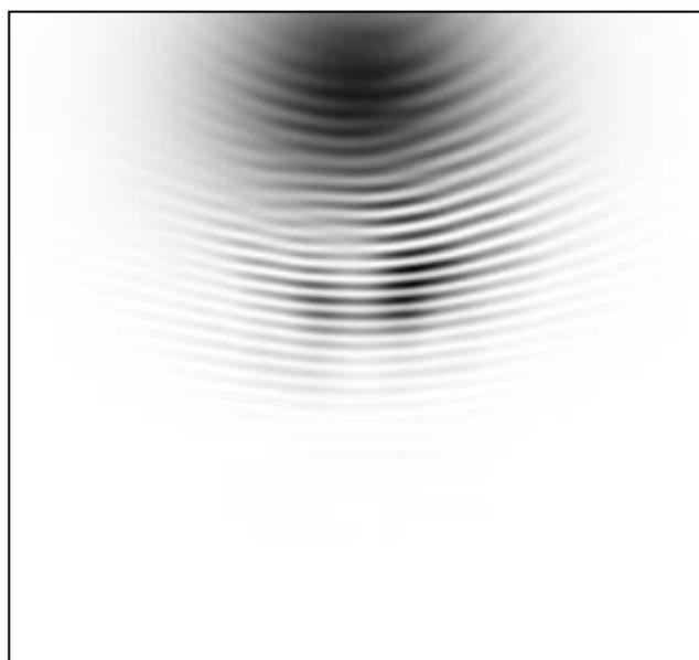
Рисунок 3.8 – Результат моделирования амплитуды интерференционной картины в плоскости измерений: 160 см на 160 см
