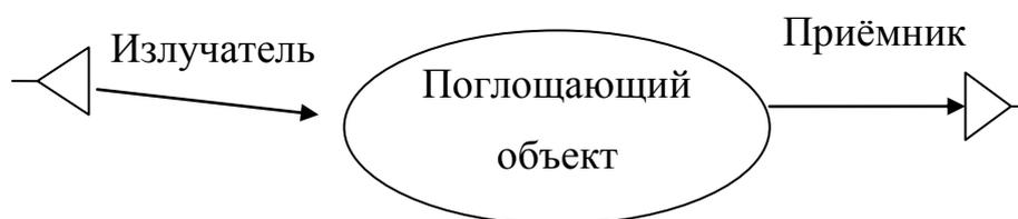
Рисунок 1.2 – Трансмиссионная схема измерений
